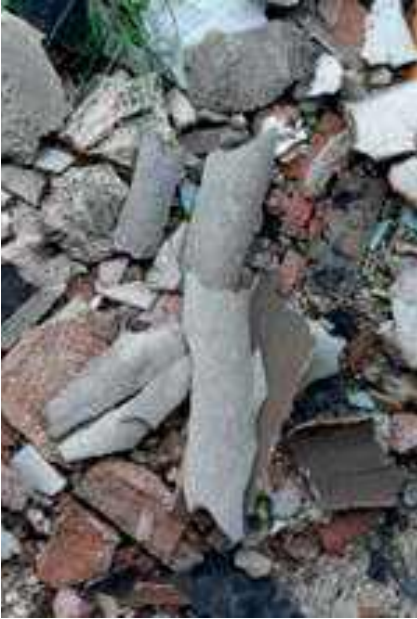
Restos de fibrocemento (Amianto). Fuente: Jose M. Valmorisco. CESSLA.
